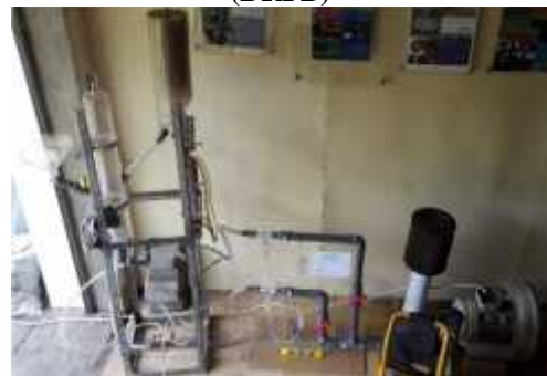
Gambar 5. Foto alat uji DRFB berbahan pipa akrilik
