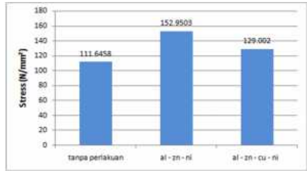
Gambar 12. Grafik perbandingan rata-rata UTS specimen tanpa perlakuan, Al – Zn – Ni, dan Al – Zn – Cu – Ni
