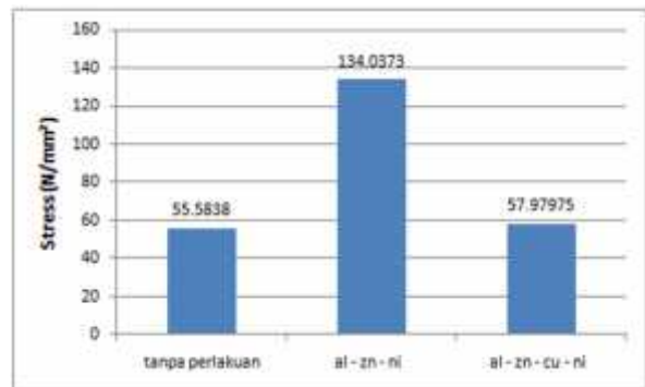
Gambar 13. Grafik perbandingan rata-rata titik putus specimen tanpa perlakuan, Al – Zn – Ni, dan Al – Zn – Cu – Ni
