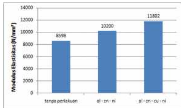
Gambar 14. Grafik perbandingan rata-rata modulus elastisitas specimen tanpa perlakuan, Al – Zn – Ni, dan Al – Zn – Cu – Ni .
