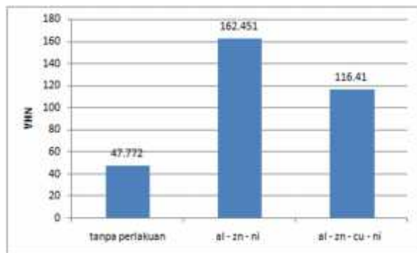
Gambar 16. Grafik perbandingan rata-rata nilai kekerasan specimen tanpa perlakuan, Al – Zn – Ni, dan Al – Zn – Cu – Ni
