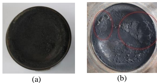
Gambar 2. Endapan yang terbentuk di head piston (a) arak bali (b) premium
