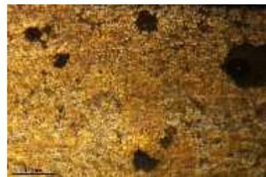
Gambar 3 Photo mikro dengan suhu *Preheat* 300°C
