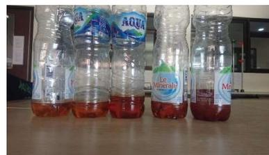
Gambar 2. Hasil minyak dari proses pirolisis
