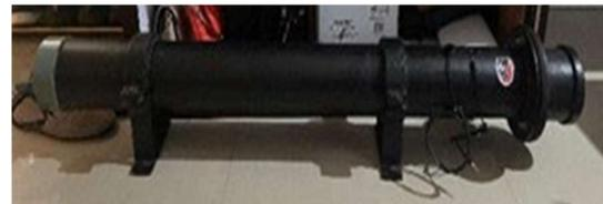
Gambar 2. Tabung Impedansi ASTM E : 1050 : 1998
