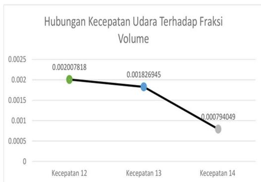
Gambar 5. Grafik Hubungan Kecepatan Udara Terhadap Fraksi Volume
