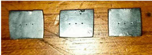
**Gambar 4. Spesimen uji Kekerasan Vickers**
