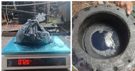
Gambar 7. Endapan Padat di dalam Reaktor
