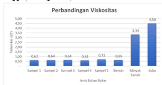
Gambar 6. Perbandingan viskositas minyak LDPE dengan BBM di Indonesia
