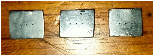
Gambar 4. Spesimen uji Kekerasan Vickers
