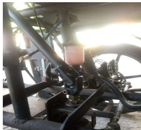
Gambar 11. Cross Joint yang langsung menyambung ke adaptor relay dari kemudi
