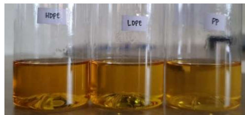
Gambar 7. Sampel Bahan Bakar Cair yang Dihasilkan pada Proses Pirolisis Variasi Jenis Sampah Plastik
