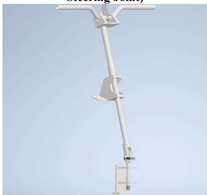
Gambar 10. Desain Sistem Kemudi Modifikasi (Single Steering Joint)
