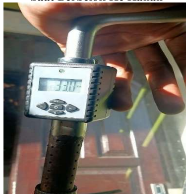
Gambar 7. Torsi Maksimal Sistem Kemudi Modifikasi Saat Berbelok Ke Kanan
