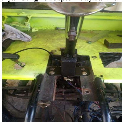
Gambar 12. Kemudi Modifikasi (Single Steering joint) dari Handle bar menuju ke crossjoint bawah
