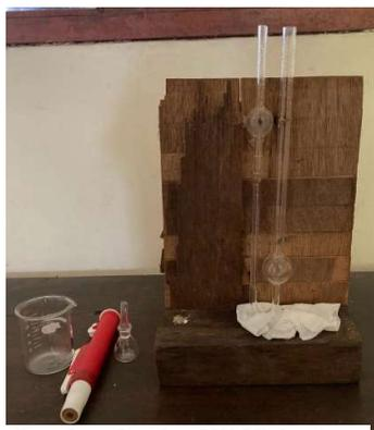
Gambar 2. Alat Uji Viskositas
