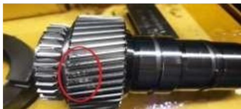
Gambar 1. Jenis Cacat Dakon pada roda gigi
