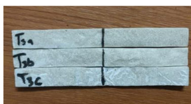
Gambar 2. Spesimen uji ketahanan bakar
