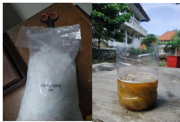
Gambar 2. Proses alkalisasi Serat daun praksok
