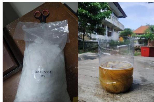
Gambar 2. Proses alkalisasi Serat daun praksok
