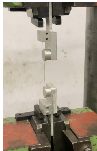
Gambar 2.1 Pengujian tarik lilitan benang emas
