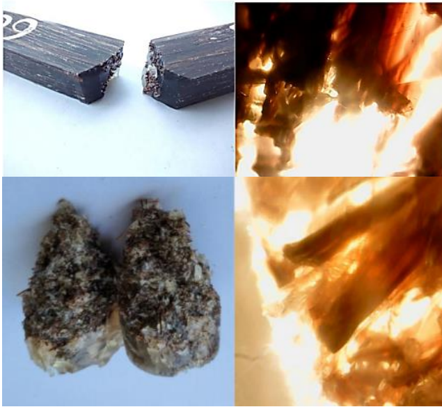
Gambar 10. Foto Makroskopik & Mikroskopik perbesaran 100x untuk spesimen uji dampak dengan waktu alkalisasi 60 menit
