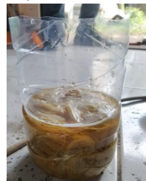
Gambar 2. Proses alkalisasi Serat daun praksok
