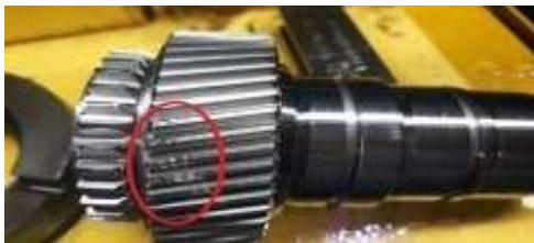
Gambar. 1. Jenis Cacat Dakon pada roda gigi
