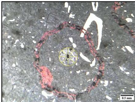
Gambar 5. Lebar Diameter Indentasi 0,514 mm
