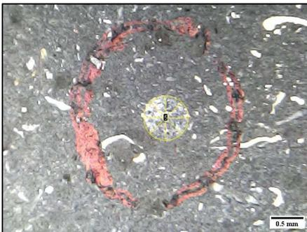
Gambar 4. Lebar Diameter Indentasi 0,489 mm
