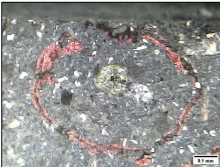
Gambar 3. Lebar Diameter Indentasi 0,419 mm
