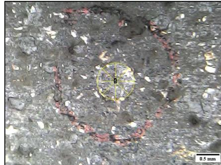
Gambar 7. Lebar Diameter Indentasi 0,595 mm
