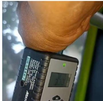
**Gambar 5. Torsi Maskimal Sistem Kemudi Lama Saat Berbelok ke Kiri**
