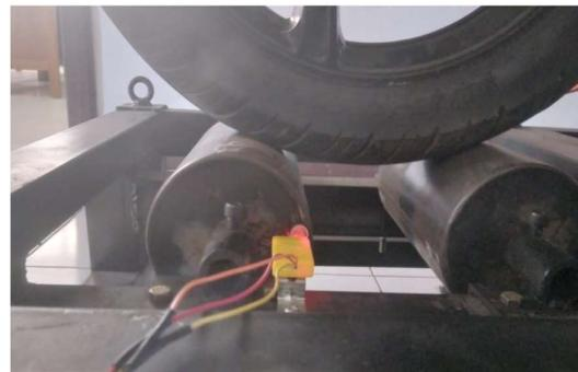
Gambar 4. 2 Hubungan Roda dan Roller
