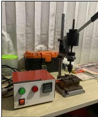
Gambar 1. Alat Uji Kekerasan
