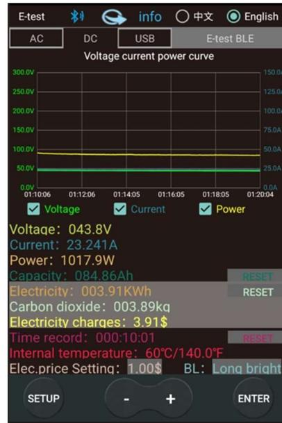
Gambar 4. 4 Kurva Tegangan, Arus dan Daya
