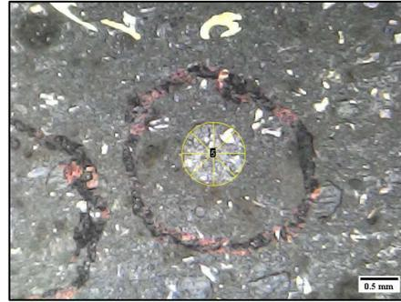
Gambar 6. Lebar Diameter Indentasi 0,547 mm
