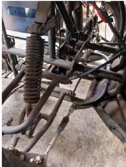
Gambar 12. duduk steering bawah yang menghubungkan Long Tie rod bagian depan kanan dan kiri dengan Tie Rod yang terhubung pada Steering Joint.
