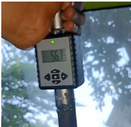
Gambar 6. Torsi Maskimal Sistem Kemudi Lama Saat Berbelok ke Kanan
