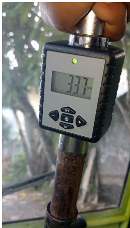
Gambar 8. Torsi Maskimal Sistem Kemudi Modifikasi Saat Berbelok ke Kanan
