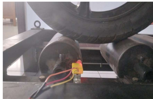
Gambar 4. 2 Hubungan Roda dan Roller
