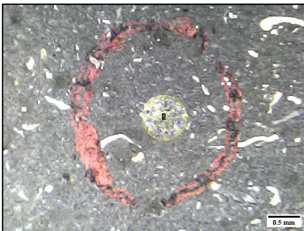
Gambar 4. Lebar Diameter Indentasi 0,489 mm
