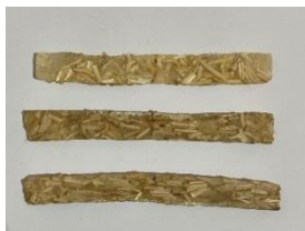
Gambar 1. Spesimen Uji Bending
