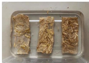
Gambar 2. Spesimen Uji Daya Serap Air
