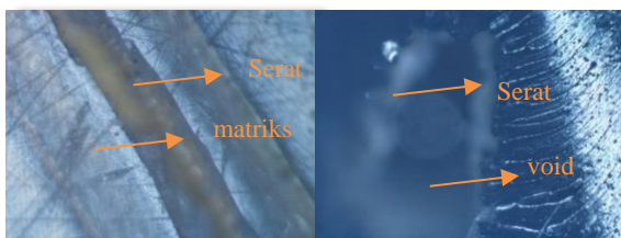
Gambar 12 Foto Mikro Fraksi 10%
