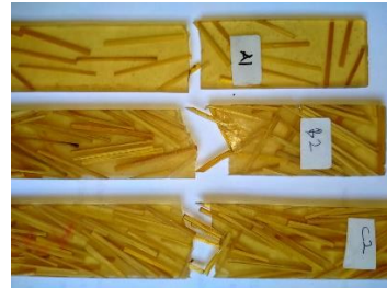
Gambar 3. Patahan Spesimen Uji
