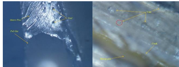
Gambar 8. Pengamatan Foto Mikro Variasi 15% batang padi
