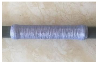
Gambar 9. Hasil Penggulungan 200 rpm
