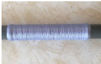
Gambar 7. Hasil Penggulungan 50 rpm
