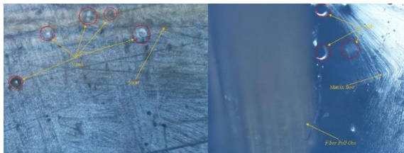
Gambar 6. Pengamatan Foto Mikro Variasi 5% Batang Padi
