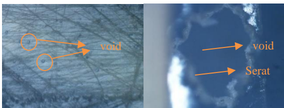
Gambar 13 Foto Mikro Fraksi 15%
