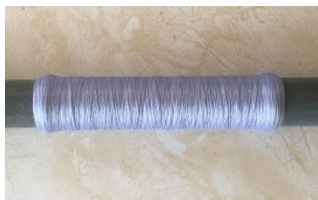
Gambar 8. Hasil Penggulungan 100 rpm
