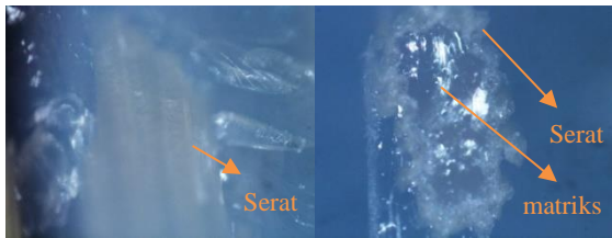
Gambar 11 Foto Mikro Fraksi 5%
