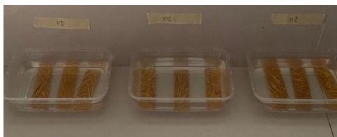
Gambar 5 Proses Uji Daya Serap Air
