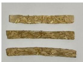
Gambar 1. Spesimen Uji Bending
