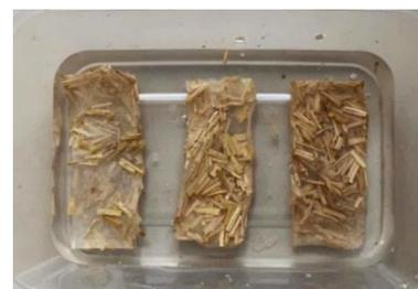
Gambar 2. Spesimen Uji Daya Serap Air
