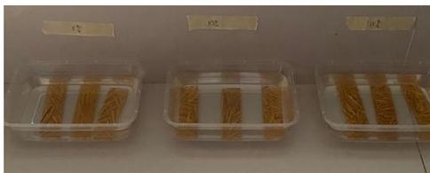
Gambar 5 Proses Uji Daya Serap Air
