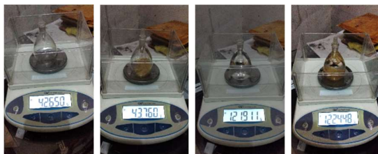
Gambar 7 Pengukuran Massa Jenis Serat
