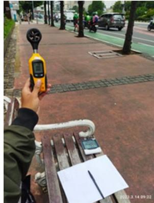
Gambar 3. Anemometer Data Logger dan Thermohygrometer
