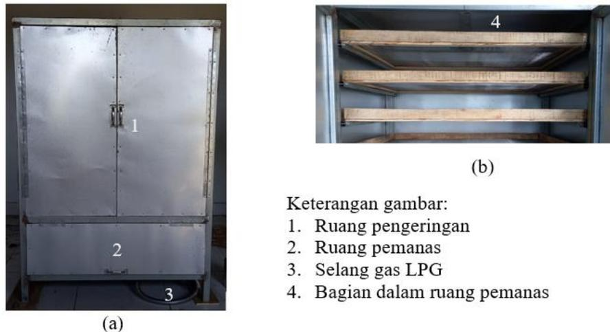
**Gambar 3.1.** Alat pengering cabai yang siap digunakan untuk memperoleh produk cabai kering siap giling dengan (a) tampilan luar (b) tampilan dalam
