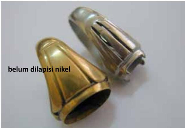
Gambar 4. Perbandingan foto produk kerajinan kuningan yang belum mengalami elektroplating dibandingkan dengan yang sudah mengalami elektroplating nikel
