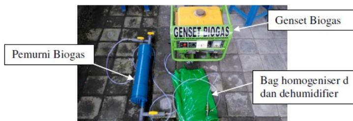
**Gambar 3.** Unit Genset biogas, Unit pemurni biogas, Unit biogas bag yang sudah siap dipasang
