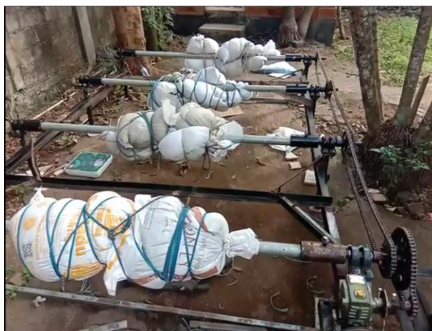
Gambar 3. Proses percobaan penggulingan babi dengan beban 200 kg.
