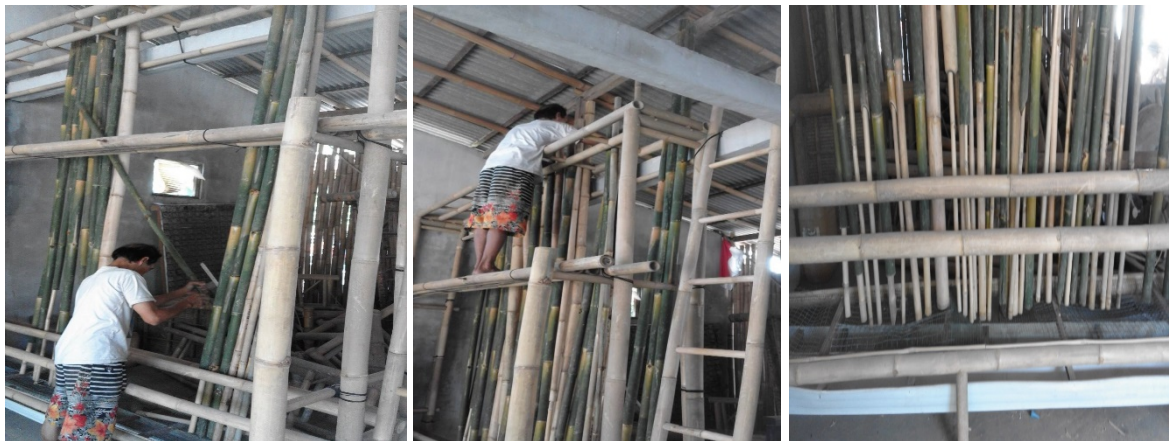
Gambar 7. Cara pengupasan kulit bagian dalam (atas) dan penempatan bambu yang akan diawetkan (bawah)
