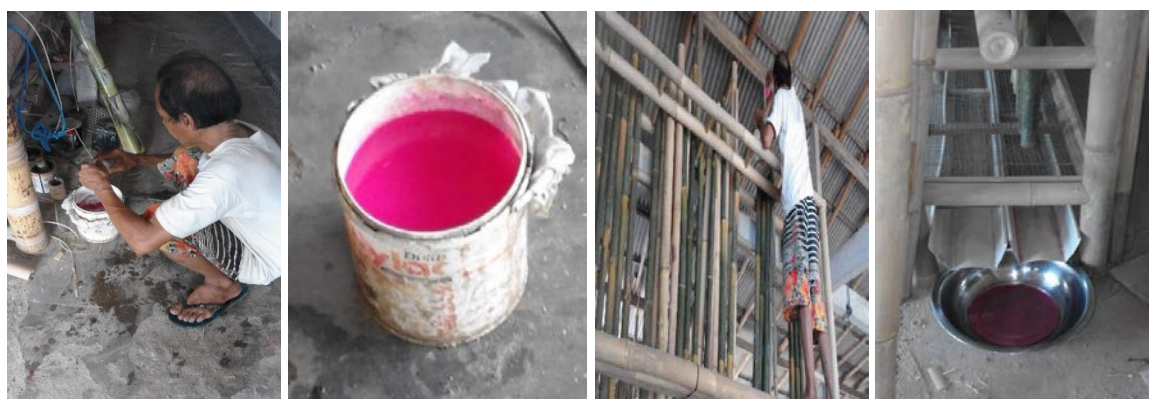
Gambar 8. Penyiapan larutan pengawet, pengisian larutan, dan penampungan larutan sisa
