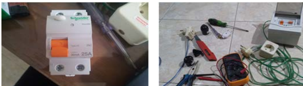
Gambar 3.4 ELCB (Earth Leakage Circuit Breaker) sebagai pengaman bahaya kebakaran dan peralatan listrik lainnya
