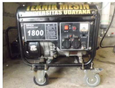
Gambar 4. Genset berbahan bakar biogas
