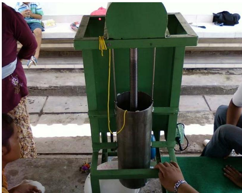
**Gambar 3.1.** Wujud Fisik Mesin Pengepres Adonan krupuk
