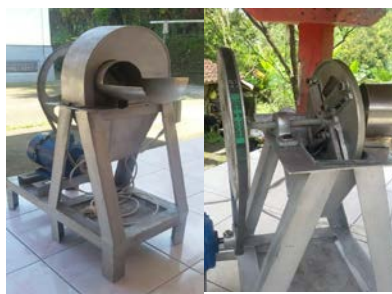
Gambar 4. Alat pemotong/pengiris umbi talas/singkong
