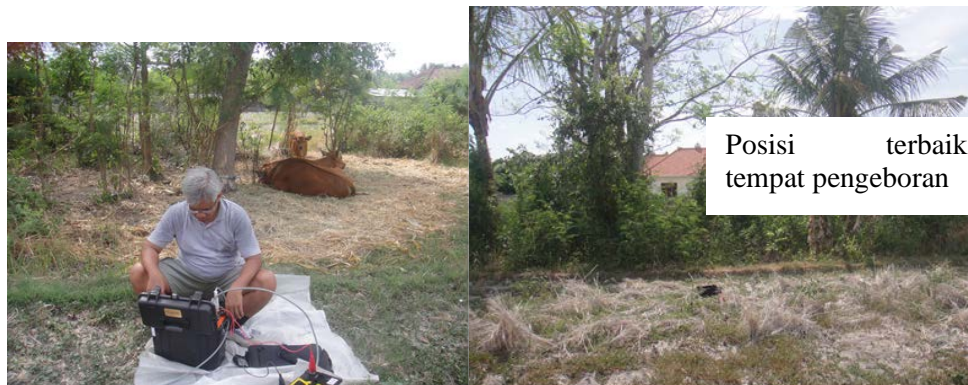
Gambar 2.1. Pengukuran dengan Set Alat Geolistrik (resistivimeter) Merk SkillPro dan posisi terbaik untuk membuat sumur bor
