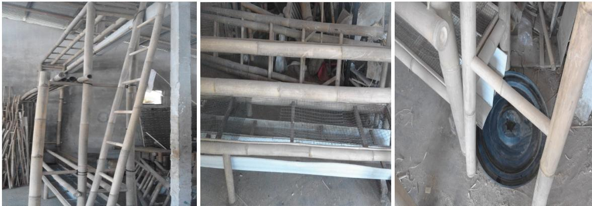
Gambar 6. Alat pengawet cara gravitasi (a) dan pipa bagian bawah penampungan cairan (b, c)
