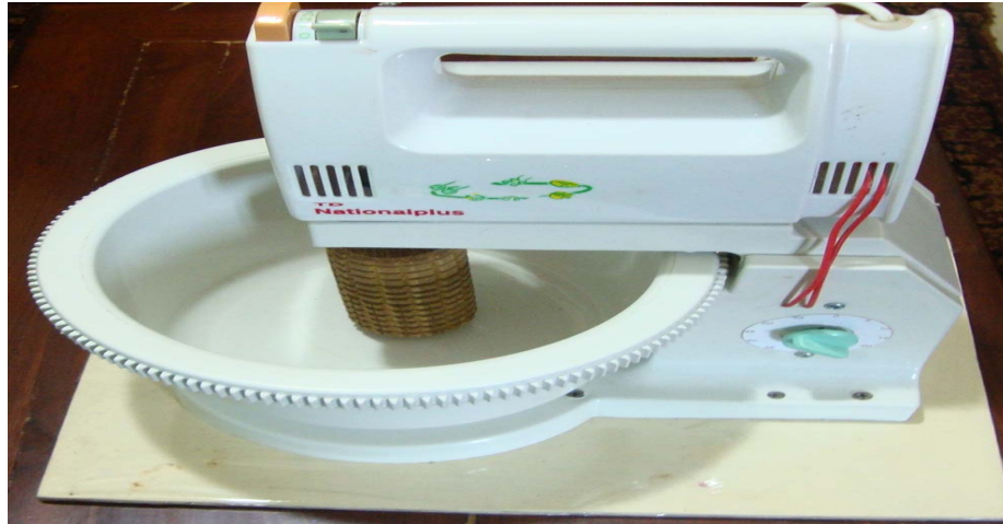
Gambar 3.2. Alat 3 in 1 untuk Mixer, Blander dan Pengupas Kacang
