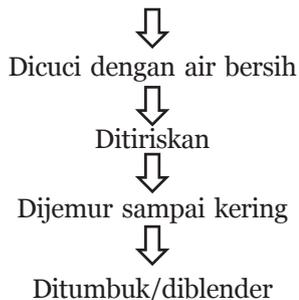
Gambar 2. Skema pembuatan serbuk daun sirih
