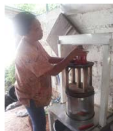
Gambar 4. Pemerasan dengan alat hidrolis
