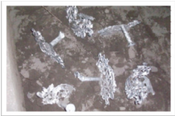
Gambar 6. Pembongkaran hasil pengecoran komponen lampu hias
