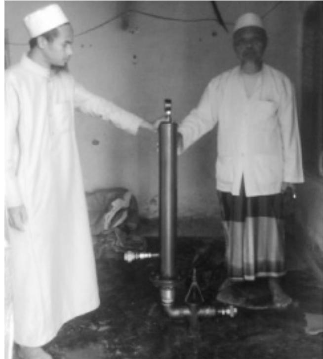
Gambar 1. Prototype pompa hidram
