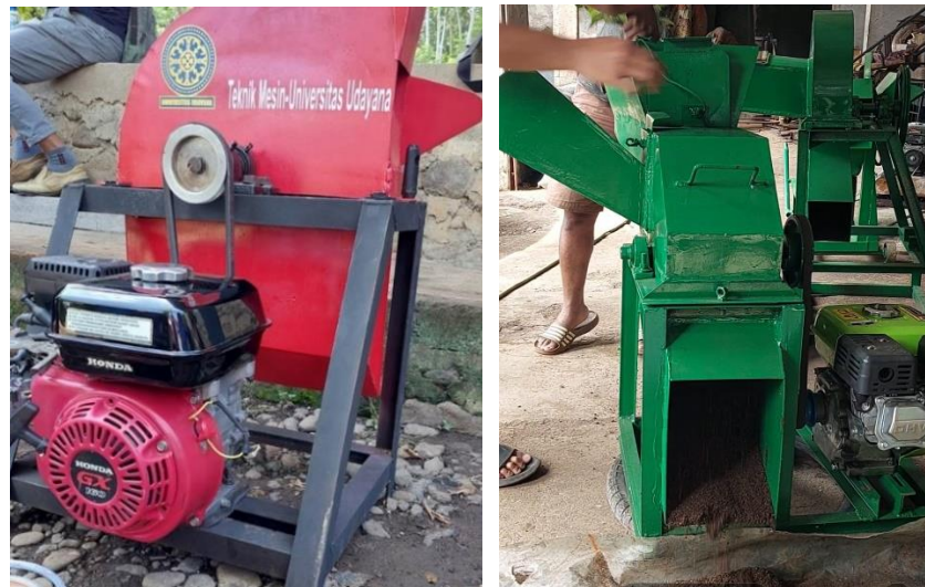
Gambar 3.1. Mesin pencacah kompos dan pemotong pakan ternak
