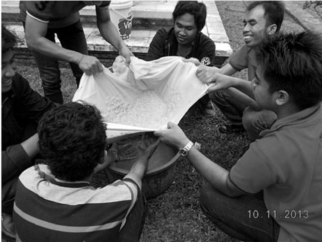
Gambar 9. Penyaringan untuk memisahkan bubur kertas dengan air
