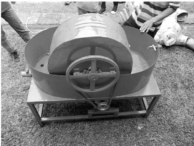
Gambar 6 Alat Pembuat mesin bubur kertas yang dirancang khusus untuk kegiatan pengabdian
