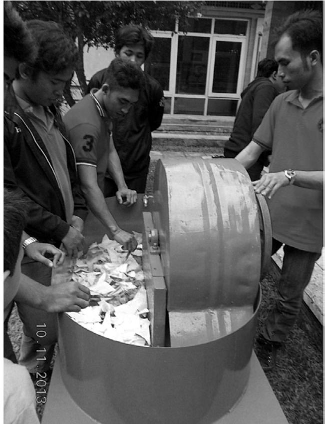
Gambar 7. Demonstrasi cara kerja alat pembuat bubur kertas
