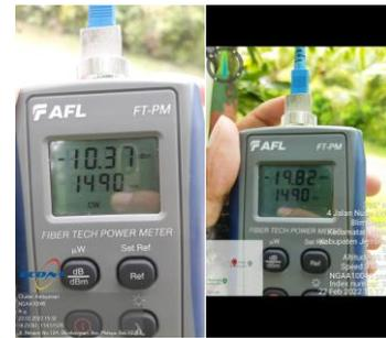
Gambar 4: Hasil Pengukuran Lapangan pada Jaringan Eksisting
