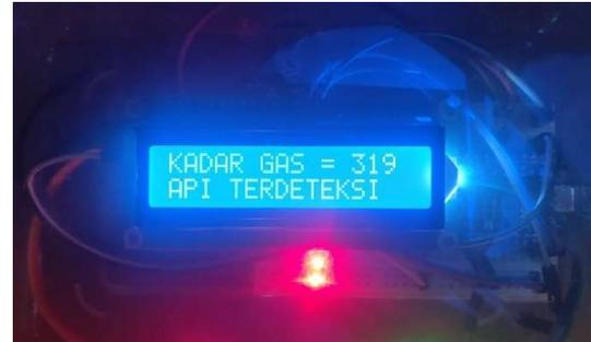
Gambar 16: Tampilan LCD saat alat mendeteksi api
