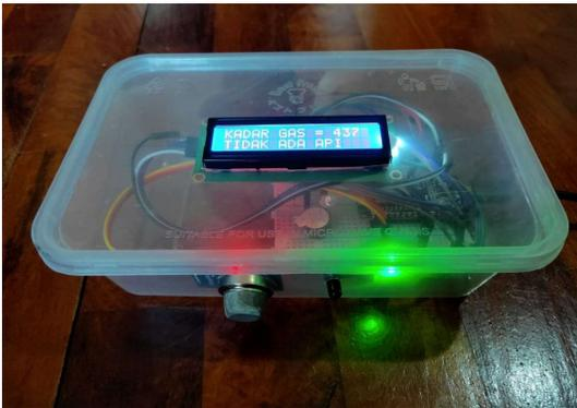
Gambar 12: Realisasi alat Pendeteksi Kebocoran Gas dan Kebakaran Dini
