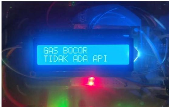
Gambar 14: Tampilan LCD saat alat mendeteksi gas tanpa api
