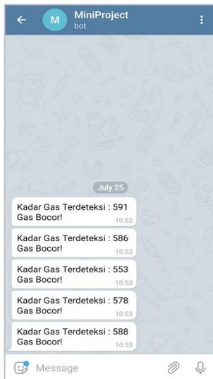
Gambar 15: Tampilan pesan Telegram saat alat mendeteksi gas
