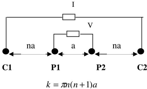
Gambar 3. Pengaturan elektroda konfigurasi Wenner-Schlumberger
