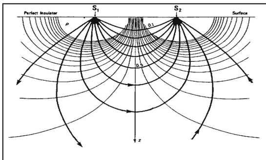
**Gambar 1.** Pola aliran arus dan bidang ekipotensial antara dua elektroda arus dengan polaritas berlawanan (Bahri, 2005)
