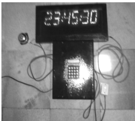
Gambar 8. Realisasi perangkat keras sistem bel sekolah otomatis berbasis mikrokontroler
