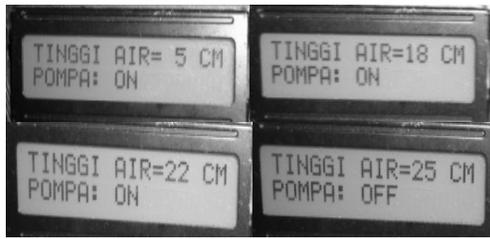
**Gambar 10. Hasil pengujian dari ketinggian minimal ke maksimal**
