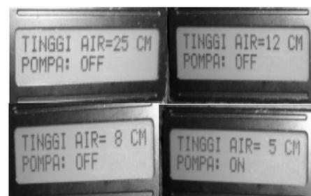
Gambar 9. Hasil pengujian dari ketinggian maksimal ke minimal
