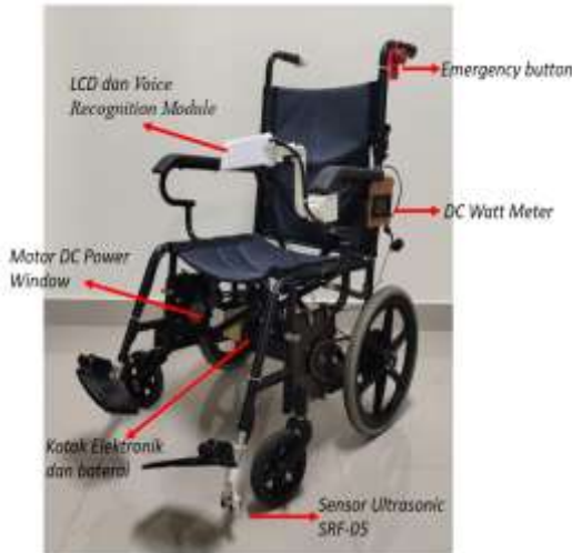
Gambar 9. Realisasi Kursi Roda Elektrik dengan Voice Recognition Module
