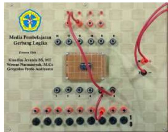
Gambar 7: Uji coba gerbang logika NOT dengan IC 7404.
