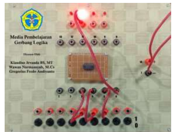
Gambar 5: Uji coba gerbang logika AND dengan IC 7411.
