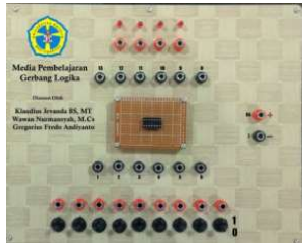
Gambar 3: Implementasi desain rangkaian gerbang logika.
