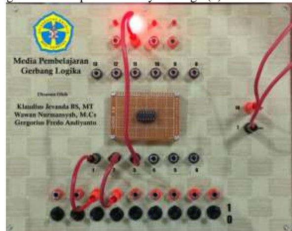
Gambar 4: Uji coba gerbang logika AND dengan IC 7408.
