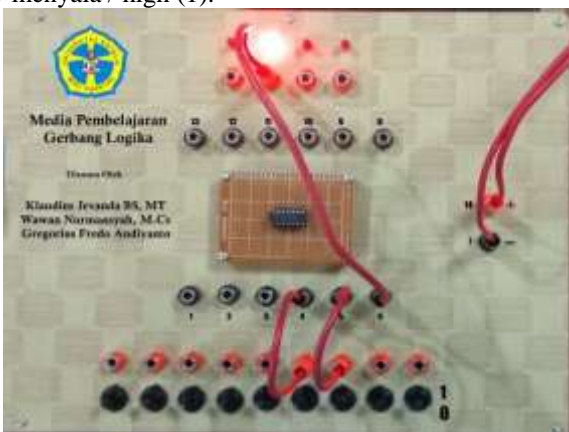
Gambar 6: Uji coba gerbang logika OR dengan IC 7432.
