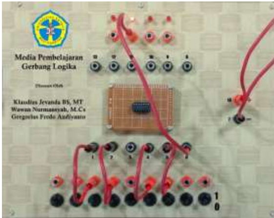
Gambar 5: Uji coba gerbang logika AND dengan IC 7421.
