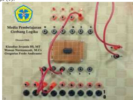
Gambar 15: Uji coba gerbang logika XNOR dengan IC 74266
