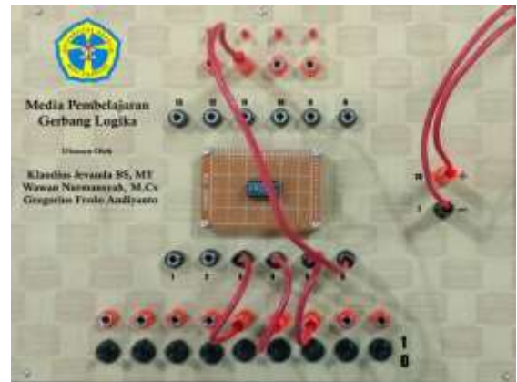
Gambar 11: Uji coba gerbang logika NAND dengan IC 7410.
