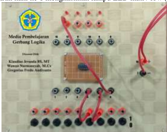
Gambar 14: Uji coba gerbang logika XOR dengan IC 7486
