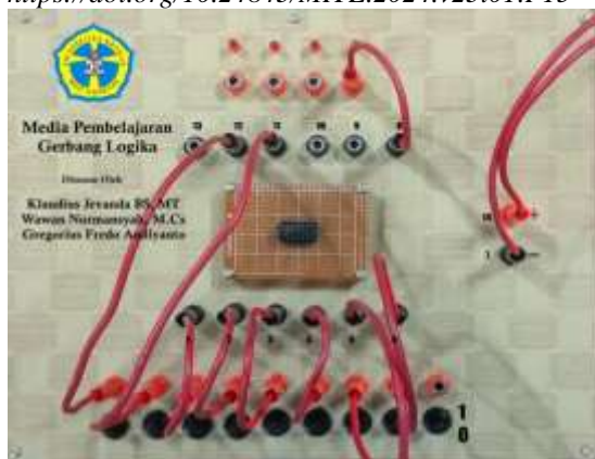
Gambar 13: Uji coba gerbang logika NAND dengan IC 7430.
