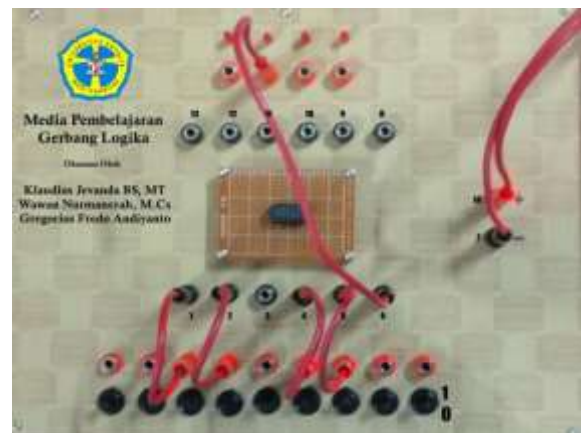
Gambar 12: Uji coba gerbang logika NAND dengan IC 7420.
