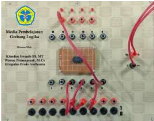
Gambar 9: Uji coba gerbang logika NOR dengan IC 7427.
