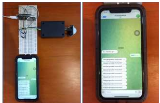
Gambar 12: Pelaksanaan pengujian subsistem komunikasi internet of things
