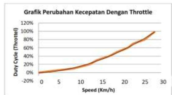
Gambar 15: Grafik Perubahan Kecepatan Sepeda Listrik dengan *Throttle*
