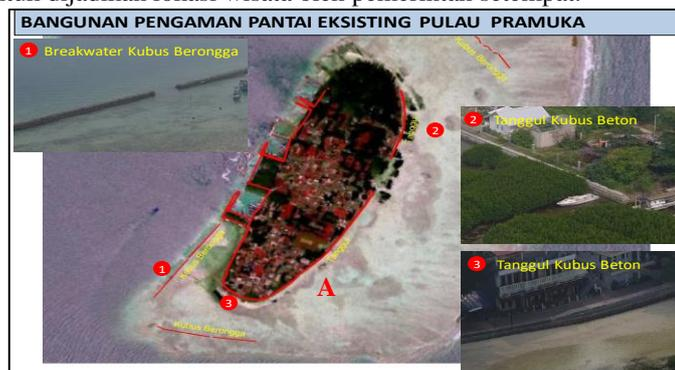
Gambar 1 Bangunan pengaman pantai eksisting di Pulau Pramuka.
