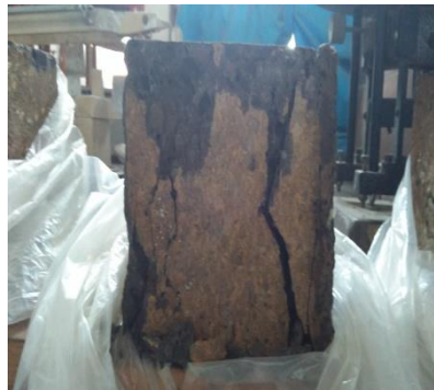
Gambar 10. Benda Uji Beton Geopolimer Setelah Pengujian Kuat Tekan
