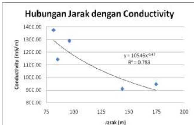
Gambar 6 . Grafik hubungan jarak dengan Conductivity
